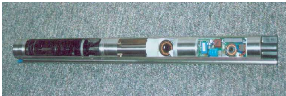
Figura 2.8 – Interior de motobomba Flex, com eletrônica de potência incorporada na carcaça do motor. (Foto: M.C. Fedrizzi, 2002)
