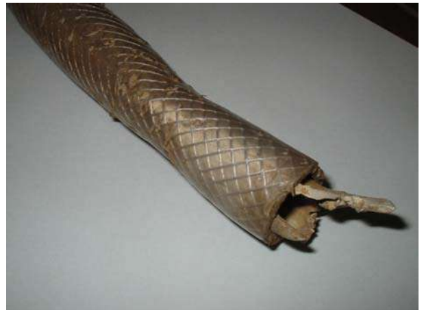
Figura 3.34 – mangueira de sucção de bomba flutuante atacada por jacaré, RDS Mamirauá, AM. (Foto: O.S. Brito, 2003)
